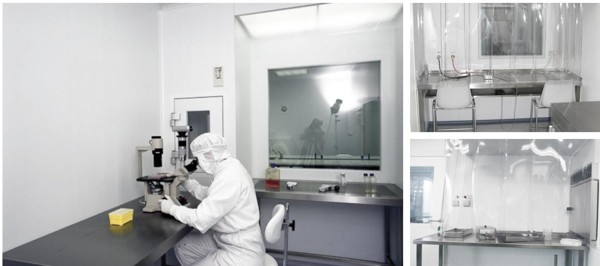
Циркуляционная установка предназначена для обеспечения подачи фильтрованного воздуха к рабочему месту для защиты продукта от окружающего заражения.
