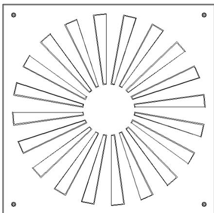
TIMOTEC-Auslass für Filter 457 mm mit 30 Lamellen
