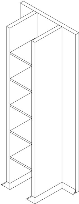
Sie ergänzen das Sortiment der Personalschleusen, insbesondere in Reinräumen der Klasse „B“. Die Regale sind eigenständig und werden zwischen den Trennwandpaneelen montiert. Sie sind in Sandwichbauweise gefertigt, Verkleidung aus Edelstahl AISI 304, Oberfläche SB.
