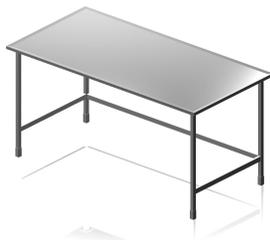
Der Arbeitstisch besteht aus einem Edelstahl-Untergestell und einer Arbeitsplatte. Die Arbeitsplatte bieten wir in drei Varianten an. Alle sind für Reinräume geeignet. Der Tisch ist geerdet. Zur Erdung des Tisches dient ein Erdungspunkt an den hinteren Tischbeinen in einer Höhe von ca. 200 mm über dem Boden. Die Tische können zu Anlagen verkettet werden.
